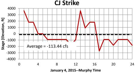
$\Delta S = (2653.89 \text{ ft} - 2653.88 \text{ ft}) * 255 \text{ acres} / 1.9835 \text{ ac-ft/cfs} = -1.29 \text{ cfs}$
